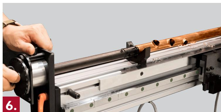
1. Posicionamento fácil e preciso do "pino furo", com placa índice em dois intervalos personalizados.
